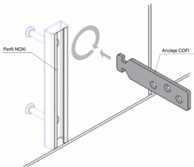
1.1.- Colocación del anclaje COFI-TL en el perfil y giro de 90°.
