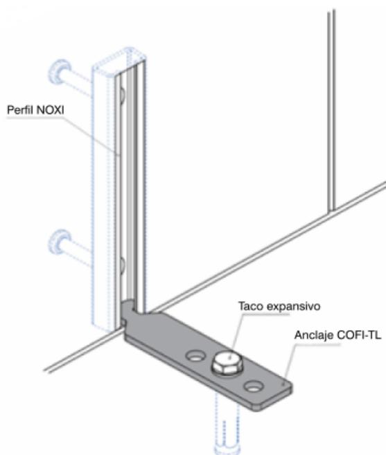
3.1.- Apretar el taco expansivo (según indicaciones del fabricante) para terminar el ensamblaje.
