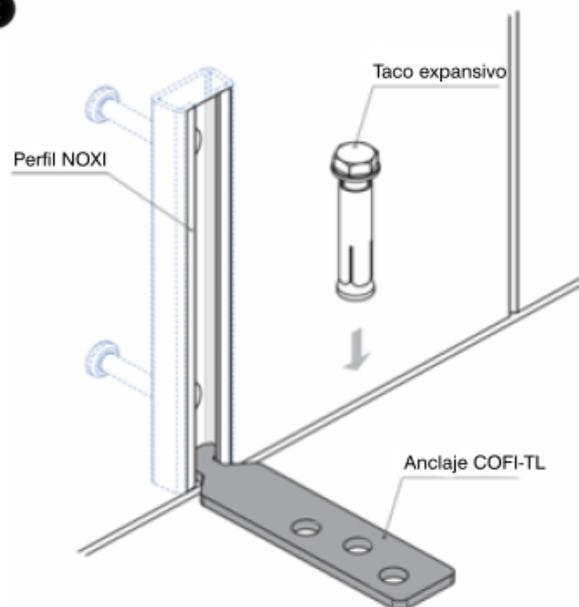
2.1.- Realización del taladro para alojar el taco expansivo de fijación en cualquier de tres Ø14.
