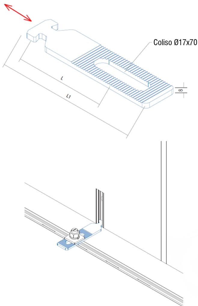
Accesorio para la retención de elementos de hormigón prefabricado. Montaje con perfiles NOXI, tornillo FER TF16-40, arandela FER AF6/16, arandela Glower AG16 y tuerca T16.
