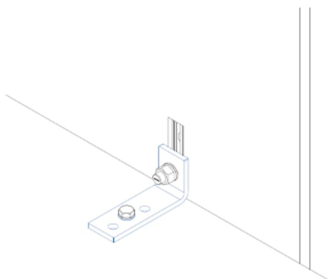
Accesorio para la retención de elementos de hormigón prefabricado. Montaje con perfil NOXI, tornillo FER TF16-40, arandela A16, arandela Glower AG16, tuerca T16 y taco expansivo. Con este sistema se consigue regulación de montaje en 2 de los 3 ejes principales.
