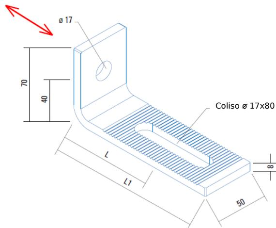
Accesorio para la retención de elementos de hormigón prefabricado. Montaje con perfiles NOXI, tornillos FER TF16-40, arandela FER AF6/16, arandelas Glower AG16, arandela A16 y tuerca T16. Con este sistema se consigue regulación de montaje en los 3 ejes principales.
