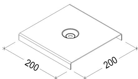
Anclaje para la retención de viguetas de hormigón continuas a solape sobre un elemento estructural de hormigón prefabricado. Montaje con casquillo roscado C10-60, varilla roscada VR10, arandela M10, arandela Glower M10 y tuerca M10.
