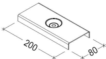
Anclaje para la retención de viguetas de hormigón continuas a testa sobre un elemento estructural de hormigón prefabricado. Montaje con casquillo roscado C10-60, varilla roscada VR10, arandela M10, arandela Glower M10 y tuerca M10.
