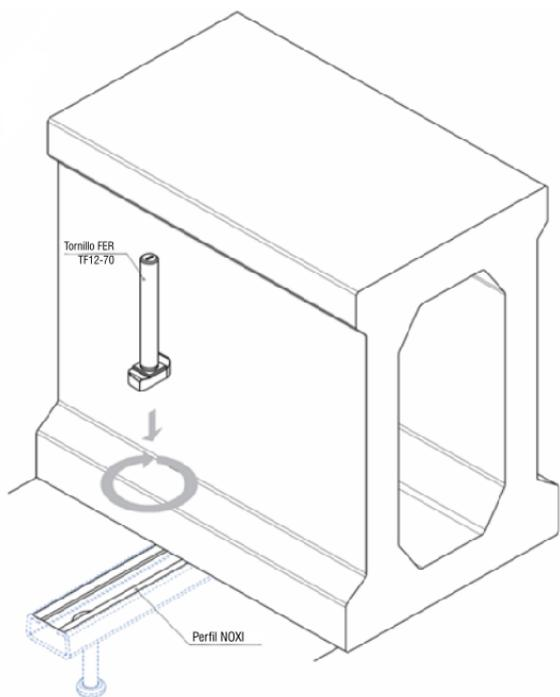
1.1.- Colocación del tornillo FER en el perfil\* y giro de 90°.
