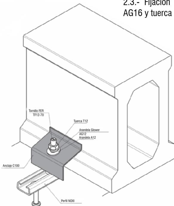
3.1.- Apretar la tuerca para finalizar el ensamblaje. Debe dejarse la arandela Glower completamente plana.
