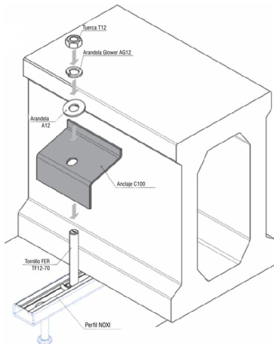
2.1.- Ensamblaje del tornillo y el anclaje a través del agujero  $\varnothing 13$ , quedando el ala más corta del anclaje en contacto con la vigueta.
