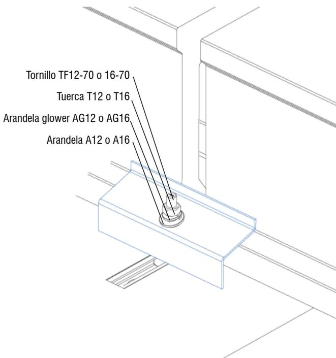
Accesorio para la retención de viguetas de hormigón continuas a testa. Montaje con perfil NOXI, tornillo FER TF, arandela A, arandela Glower AG y tuerca T. Con este sistema se consigue regulación de montaje en 2 de los 3 ejes principales.
