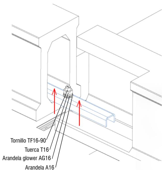
Accesorios para la retención de viguetas tubulares de hormigón continuas. Montaje con perfil NOXI, tornillo FER16-90, arandela A16, arandela Glower AG16 y tuerca T16. Con este sistema se consigue regulación en 2 de los 3 ejes principales.
