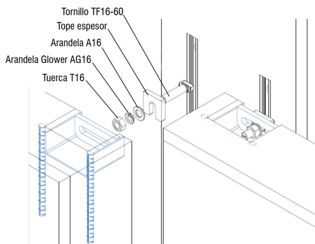
Accesorio oculto para retención de elementos de hormigón prefabricado horizontales. Montaje con tornillo FER TF16-60, perfil NOXI, arandela A16, arandela Glower AG16, tuerca T16 y topes de espesor de 3, 5, 10 y 15 mm. Con este sistema se consigue regulación de montaje en los 3 ejes principales.
