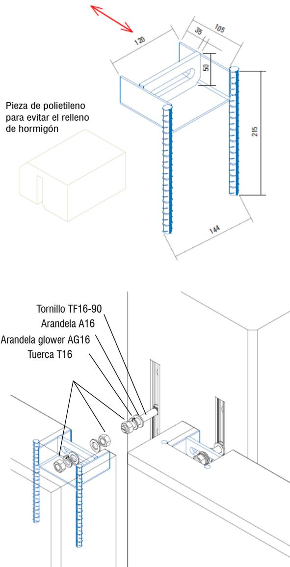
Accesorio oculto para la retención de elementos de hormigón prefabricado horizontales.
