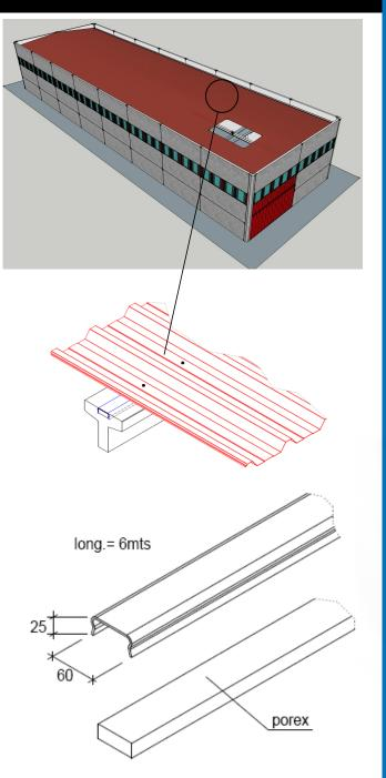
Anclaje para la fijación de cubiertas de chapa sobre un elemento prefabricado de hormigón. Montaje mediante tornillos autorroscantes.
