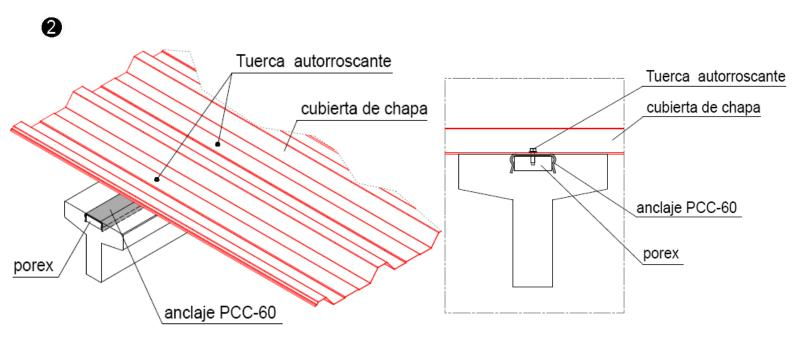
2.1.- Comprovación final y aseguramineto del apriete de los tornillos autorroscantes.
