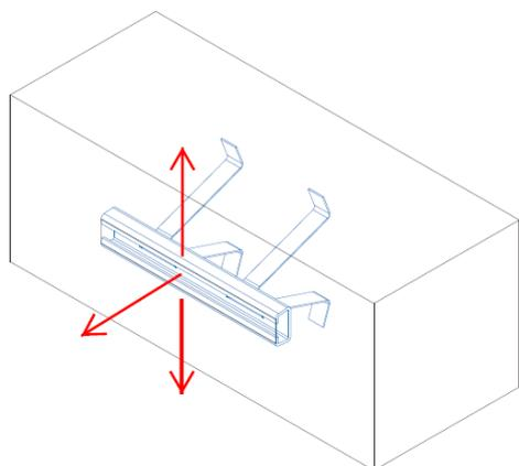
Perfil para insertar en módulos de hormigón prefabricado mediante conexión con láminas de acero.
