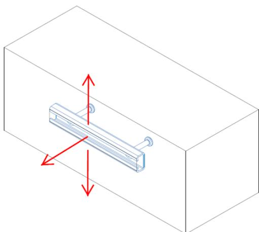
Perfil para insertar en módulos de hormigón prefabricado mediante conectores rígidos.
