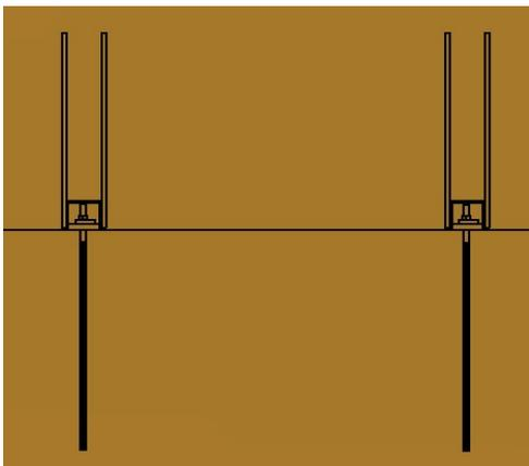
3.1.- Aproximar los paneles y a medida que el tornillo TN se introduce en el cuerpo del PPR colocar la arandela cuadrada y una tuerca.
