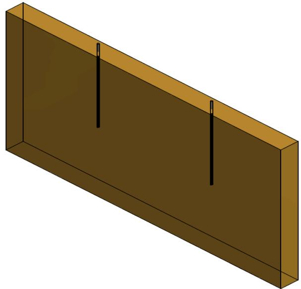
2.1.- Colocar los tornillos TN dentro del molde y tirar el hormigón.
