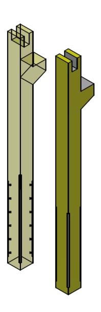
Una vez hormigonado el soporte, comprobar que el protector ha quedado alineado con la esquina del soporte y que no presenta ningún defecto que haya podido ser ocasionado durante la fase de montaje.
