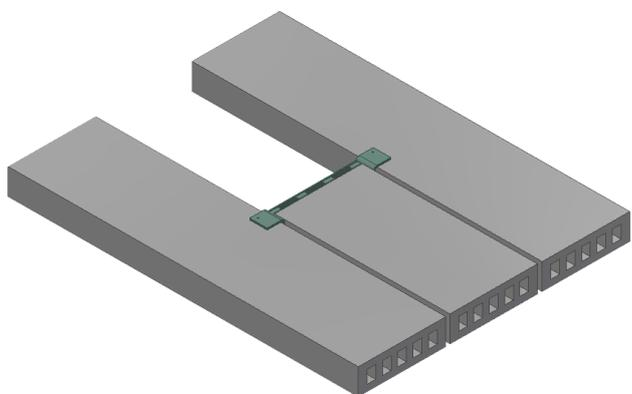
Ejemplo de montaje de un soporte SOPRA apoyado sobre dos placas alveolares.
