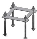
Tanto para los anclajes cortos como para los largos, se necesita una plantilla de colocación para asegurar que están correctamente colocados los anclajes en la cimentación, muro, pilar, etc. La plantilla debe garantizar la distancia entre ellos y ser suficientemente rígida.
