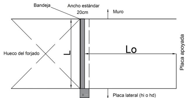
Si las placas donde se apoya el soporte tienen alturas diferentes hay que indicarlo en las casillas hd y hi. Si las placas son de la misma altura, sólo rellenar la casilla h
