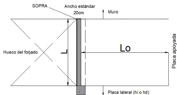
La cota L se refiere al ancho del hueco del forjado.
