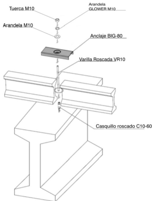
1. **Enroscar la varilla roscada VR10 en el casquillo C10-60** embebido en el elemento estructural de hormigón.
