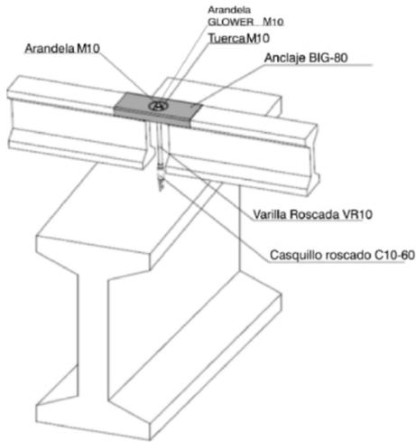
6. **Comprobar** que todos los elementos estén en la posición correcta
