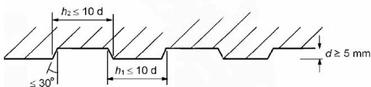
Figura 5.1 Dimensiones del grecado según EN1992-1-1:2010
