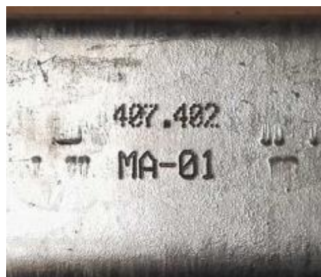
Figura 8.1 MA marcada mediante picado en frío
