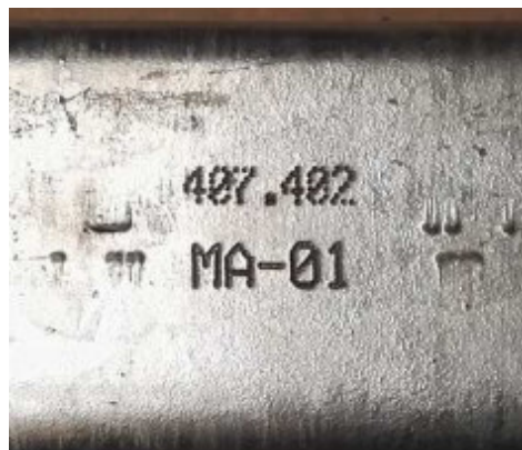
Figura 8.1 MA marcada mediante picado en frío
