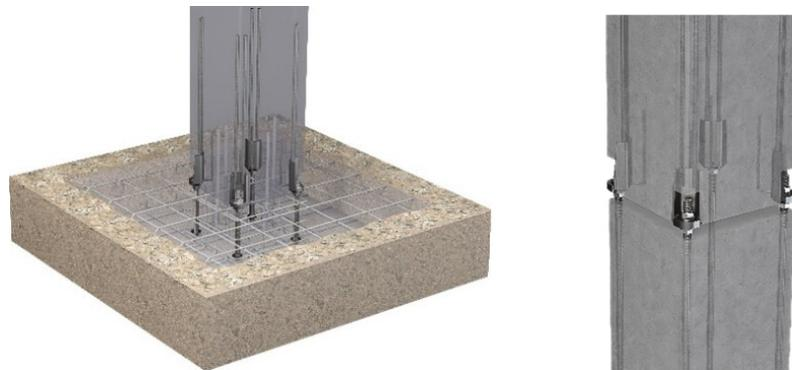
Figura 2.1 Ejemplos de uso: Caso de conexión a cimentación y empalme de pilares
