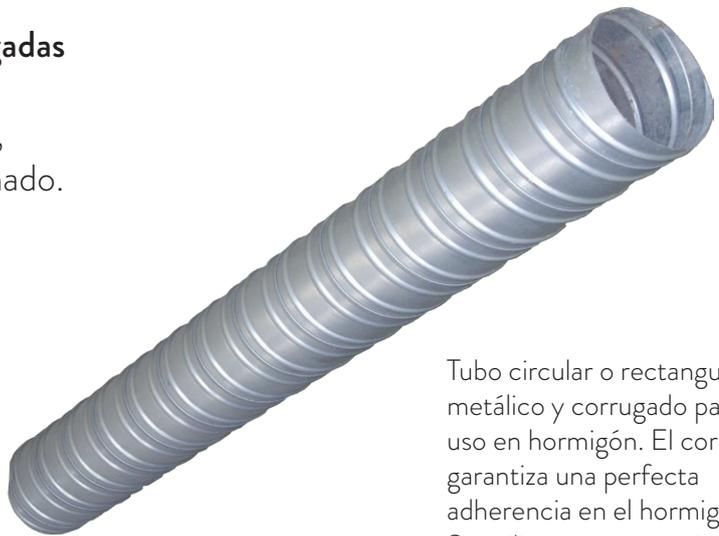
Tubo circular o rectangular, metálico y corrugado para su uso en hormigón. El corrugado garantiza una perfecta adherencia en el hormigón. Se utiliza como conexiones estructurales. Genera un espacio donde pueden colocarse el armado del elemento estructural.
