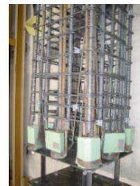
Cajas de instalación para los pies de pilar. Con estos elementos se evita llenado de las zonas del pie de pilar para posterior ensamble de los anclajes roscados TN. Estas cajas de instalación se deben quitar una vez el pilar sale del molde y recuperarse para la producción del siguiente pilar (si las cajas son metálicas).
